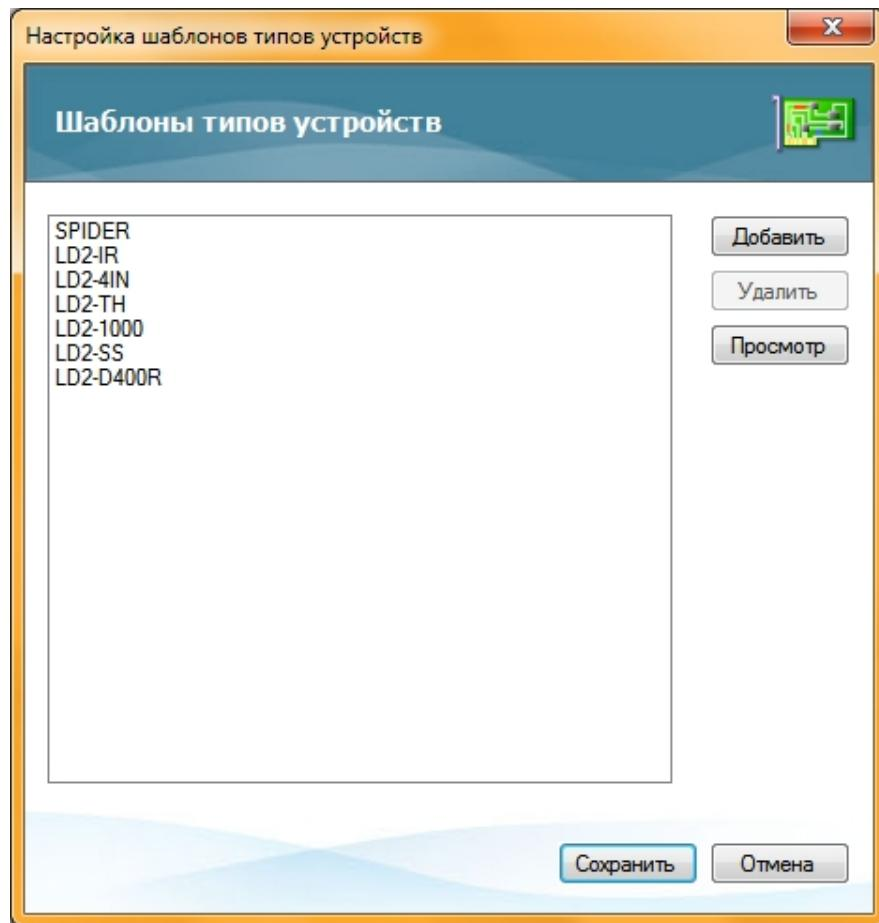
На рисунке изображен редактор шаблонов, содержащий некоторый набор базовых типов устройств LanDrive2. При выборе конкретного типа и нажатии кнопки Просмотр (или двойного клика в списке шаблонов) откроется непосредственно редактор выбранного типа.
